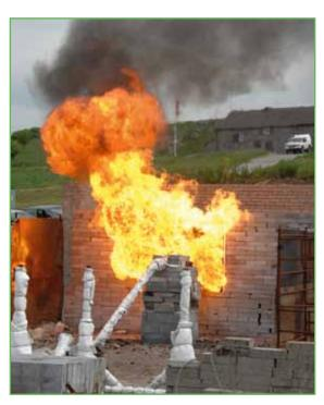
JET FIRE TESTED ACCORDING TO ISO 22899-1:2007 AND ISO/ CD 22899-2
