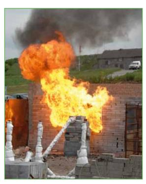
JET FIRE TESTED ACCORDING TO ISO 22899-1:2007 AND ISO/ CD 22899-2
